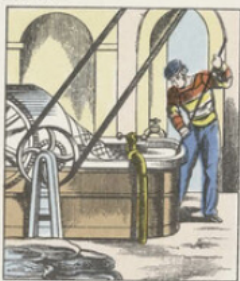
Une fois blanchis, les chiffons sont mis dans la pile défilante , qui les réduit en pâte ou pâte grossière. Cette pâte est alors conduite dans la pile raffineuse qui lui donne une homogénéité complète. C'est dans cette dernière pile que s'opère le plus souvent le collage et la coloration de la pâte.
