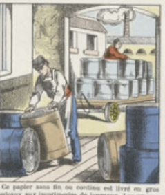
Ce papier sans fin est enroulé sur un gros rouleau aux imprimeries de journaux. Les presses à journaux sont alors réglées en ce qu'elles sont constituées au préalable par deux cylindres garnis des formes ou clichés entre lesquels le papier, passé enroulé, s'imprime à la fois recto et verso. À l'issue sont : une coupeuse qui coupe le journal aux dimensions voulues, et une plieuse qui le plie.
