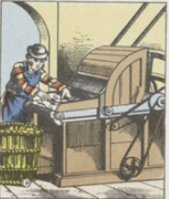
Afin de pouvoir travailler les chiffons, on les soumet à une COUPEUSE mécanique qui les débite en menus fragments. Cette machine peut ainsi couper chaque jour plusieurs milliers de kilogrammes de vieux chiffons.
