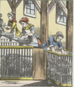
La fabrication mécanique du papier est, à peu près, la seule employée aujourd'hui. Les chiffons de tous genres qui constituent la matière première subissent d'abord deux opérations préliminaires qui se font à la main : le triage et le défilage.
