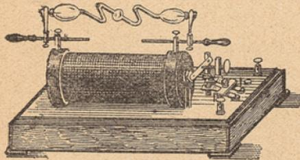
La bobine proprement dite est montée sur un socle en acajou renfermant le condensateur. Sur le devant du socle se trouvent deux bornes destinées à amener le courant de la pile. Sur les joues de la bobine se trouvent deux petites bornes après lesquelles on attache les fils conducteurs servant à faire les expériences.
