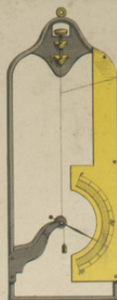
HYGROMÈTRE à cheveu Appareil servant à mesurer la quantité d'humidité de l'atmosphère.
