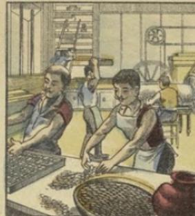
Dans les grandes usines où se fabrique le chocolat, les graines de cacao, après triage et épuration à la machine ou à la main, sont introduites dans des broyeurs en tôle où s'opère la torréfaction. Elles sont ensuite mises à refroidir sur des claies; puis à leur écouage qui se pratique dans deux cylindres concaveurs armés de broches: celles-ci, brisant les cosques, mettent les amandes à nu et les en séparent.
