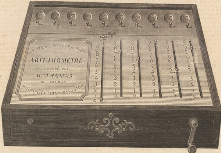
Arithmètre. — Machine à calculer de M. Thomas (de Colmar).
