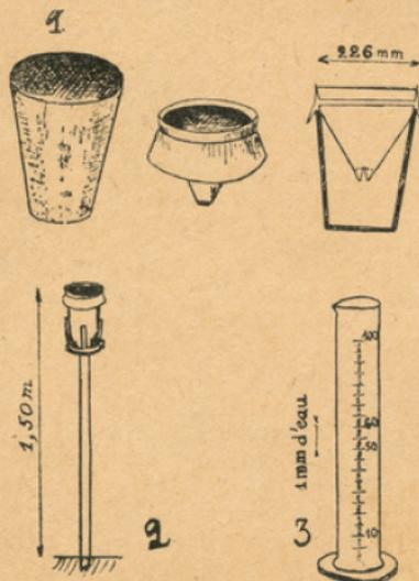
On peut donc recueillir l'eau des précipitations dans un récipient quelconque, à condition, toutefois, que sa surface en soit déterminée avec précision, que l'eau recueillie ne puisse s'en écouler, ni s'en échapper en rejaillissant, ni s'en évaporer, et que, d'autre part, son emplacement soit bien choisi, éliminant l'influence du vent et des obstacles (voir croquis), à 1,50 m du sol environ, pour la commodité des manipulations.
