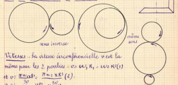
Vitesses - La vitesse circonférencielle  $v$  est la même pour les 2 poulies  $v = \omega_1 R_1 = \omega_2 R_2$  (1)
